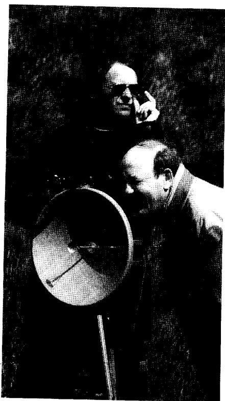
Het gecombineerde 47 en 76 GHz station van OZ/DB6NT. DC0DA kijkt door de kijker voor het uitrichten van de parabool, DB6NT geeft aanwijzingen.
